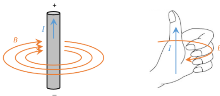
Abbildung 30: Magnetfeld eines stromdurchflossenen Leiters. Mit der linken-Hand-Regel lässt sich die Orientierung des Magnetfeldes bestimmen: Der Daumen zeigt in Elektronenflussrichtung, die restlichen Finger geben die Richtung des Magnetfeldes wieder. [32]
