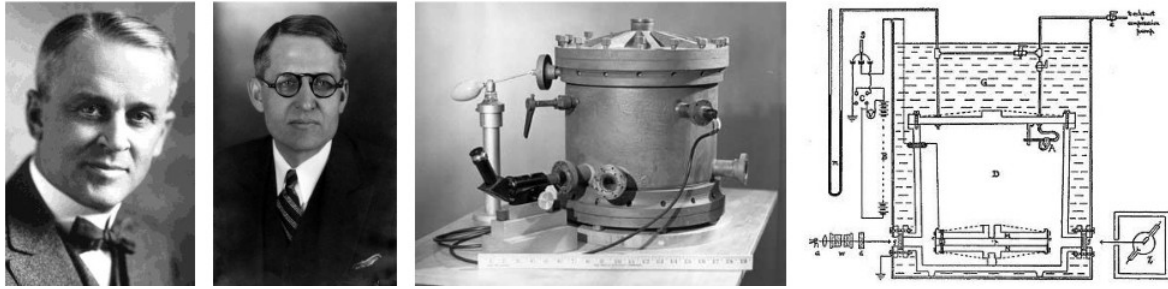
Abbildung 62: V.l.n.r: Robert Andrews Millikan, sein Doktorand Harvey Fletcher, die Versuchsap- paratur, Schematischer Aufbau [59]
